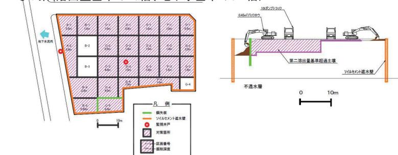
第二溶出量基準超過土壌は、場外搬出し、その他は原位置封じ込め措置
